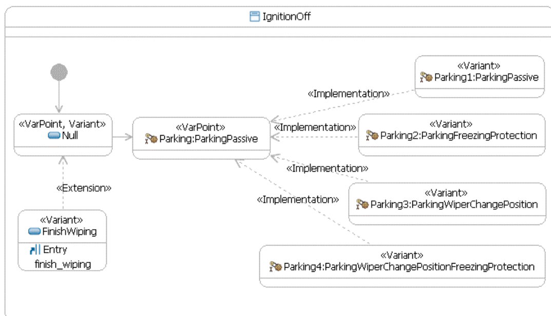
Abbildung 10: Variantenreiches Prozessmodell – UML-Zustandsdiagramm „IgnitionOff“
