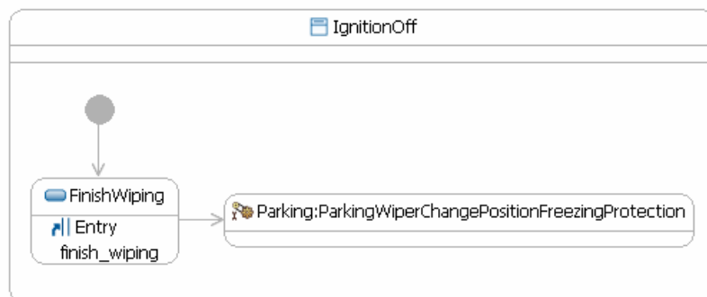
Abbildung 13: Spezifisches Prozessmodell – UML-Zustandsdiagramm „IgnitionOff“
