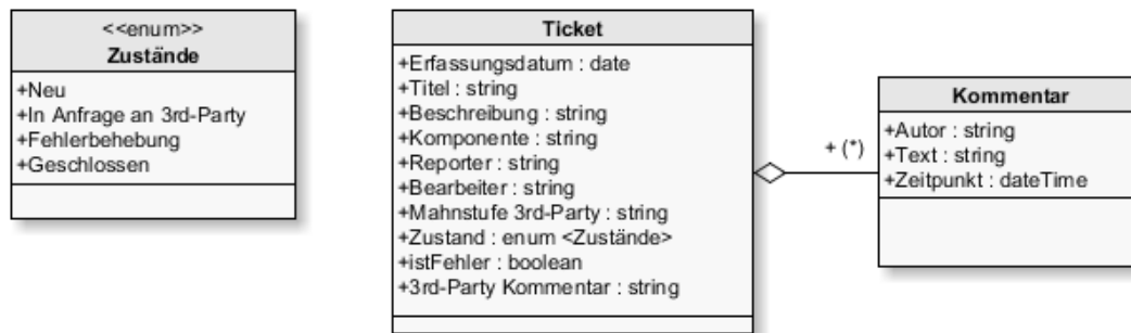
Abbildung 11: UML-Datenmodell zum Beispielprozess Ticketbearbeitung
